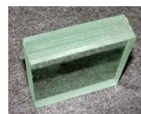
Vetro stratificato antisfondamento antiproiettile
